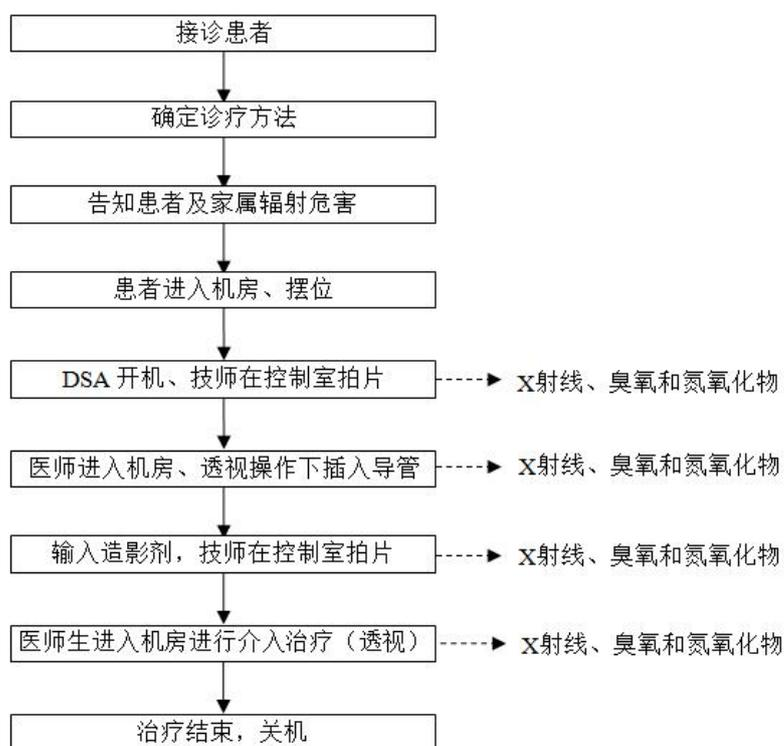
图9-3 DSA操作流程及产污环节
